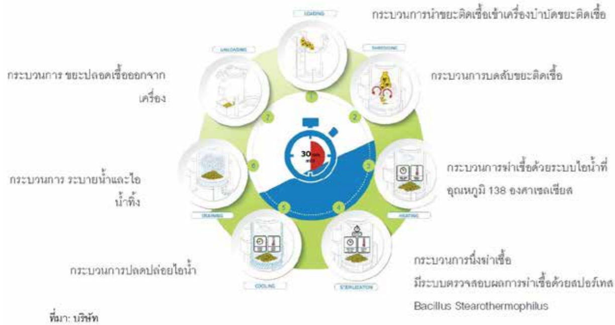
แผนภาพขั้นตอนการทำงานของเครื่องบำบัดขยะ สำหรับงานบำบัดขยะติดเชื้อทางการแพทย์ของบริษัท
